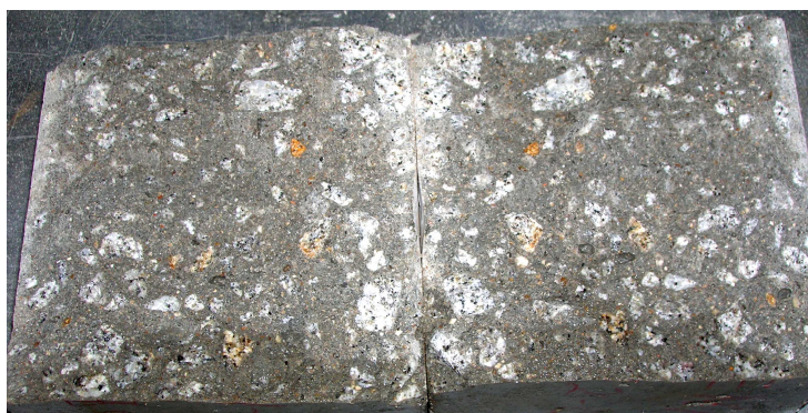
Fig.50 – Aspecto dos provetes no final do ensaio de determinação da profundidade de penetração da água sob pressão.
