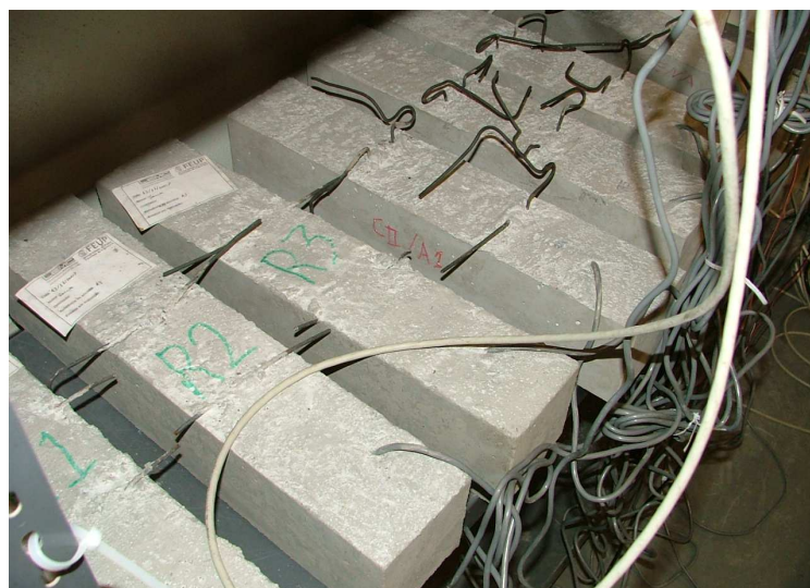
Fig.43 – Registo da retracção nos provetes de betão do estudo em causa.
