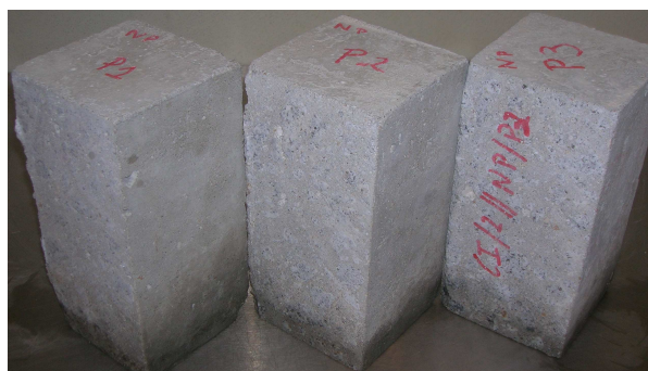
Fig.47 – Aspecto dos provetes utilizados na determinação da absorção de água por capilaridade.
