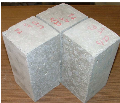
Fig.54 – Provetes resultantes da serragem dos cubos com 200 mm de aresta para utilização no ensaio de determinação da resistência à carbonatação.
