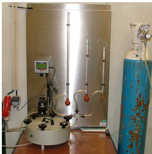
Fig.52 – Equipamento de ensaio da determinação da permeabilidade ao oxigénio.
