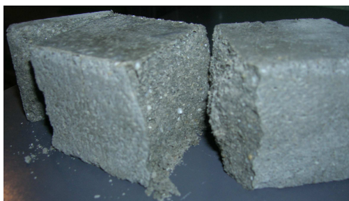
Fig.26 – Aspecto de um provete de argamassa após ter sido ensaiado à compressão.
