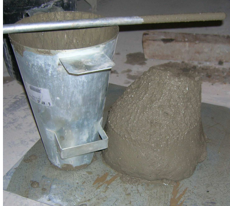
Fig.31 – Aspecto do slump obtido nos betões em estudo.
