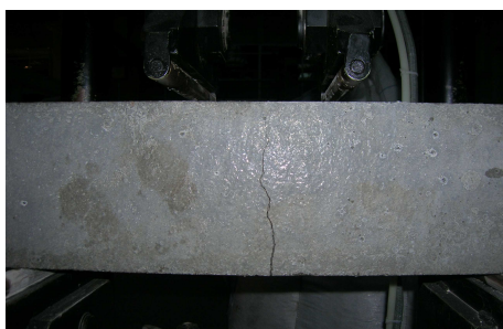
Fig.34 – Aspecto final de um prisma de betão ensaiado à flexão.
