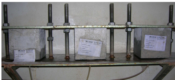
Fig.49 – Montagem utilizada para a determinação da profundidade de penetração de água sob pressão.
