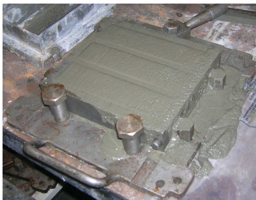
Fig.23 – Molde utilizado para a produção de argamassas com uma argamassa pronta.
