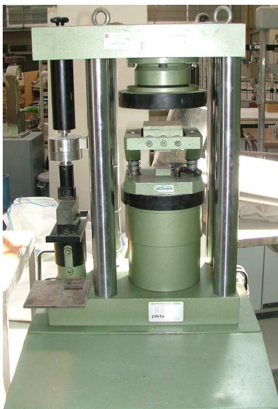
Fig.24 – Equipamento utilizado para a determinação das resistências mecânicas de argamassas.
