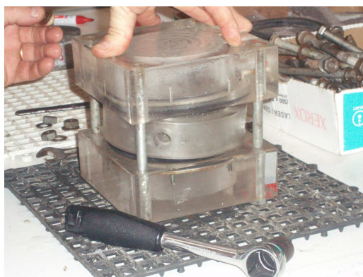
Fig.58 – Montagem do provete na célula de ensaio.
