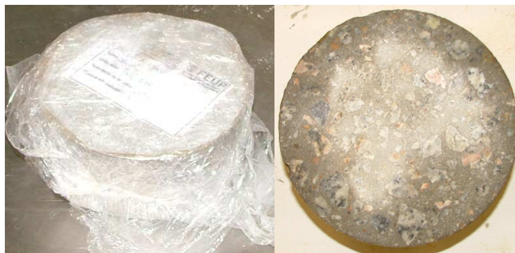
Fig.51 – Aspecto dos provetes de betão durante o pré-acondicionamento, imediatamente antes do ensaio – à esquerda – e após o ensaio – à direita.
