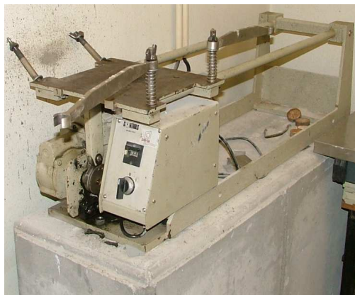
Fig.22 – Compactador utilizado para a compactação de argamassas, cumprindo os requisitos da NP EN 196 – 1 (1996).
