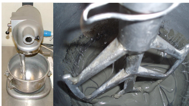
Fig.21 – Misturadora utilizada para a produção de argamassas, cumprindo os requisitos da NP EN 196 – 1 (1996).
