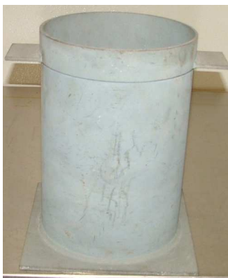
Fig.29 – Recipiente utilizado para a determinação da baridade e volume de vazios dos agregados utilizados.
