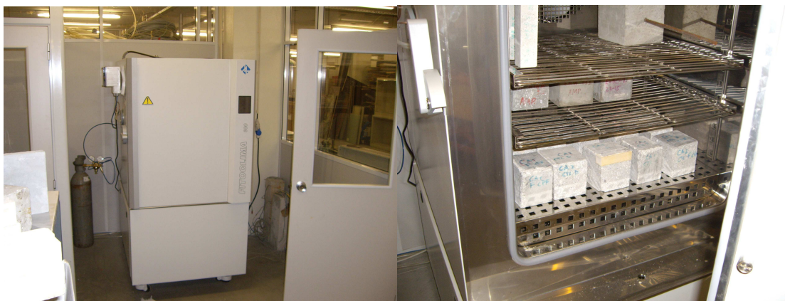
Fig.55 – Câmara utilizada para o ensaio de determinação da resistência à carbonatação.
