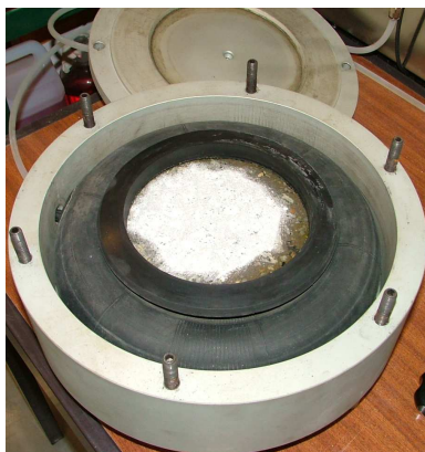
Fig.53 – Proвете de betão montado no interior do equipamento de ensaio da determinação da permeabilidade ao oxigénio.
