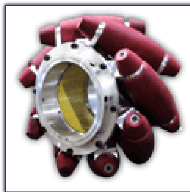
Figura 9 - Roda omnidireccional com configuração Swedish-45 [12].
