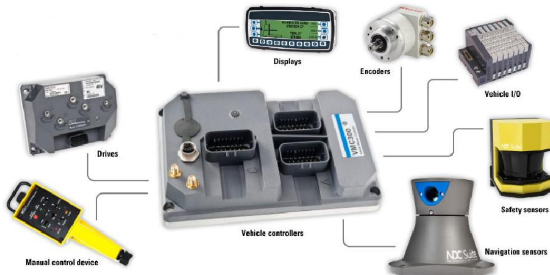
Figura 5 - Sistema de hardware utilizado num AGV pela empresa Danaher [5].
