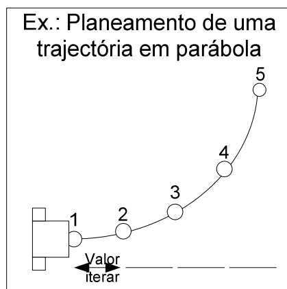
Figura 18 - Planeamento de uma trajectória em parábola seguindo o primeiro método.
