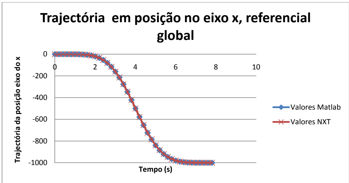
Figura 53 – Evolução da trajectória do veículo em posição, no eixo x do referencial global.
