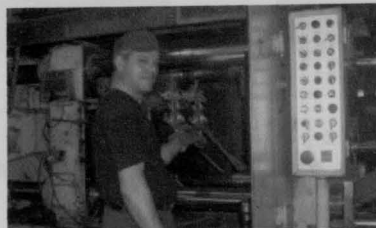
Figura 20 - Lubrificação e retirada do gito manualmente
