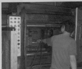
Figura 20 - Lubrificação e retirada do gito manualmente
