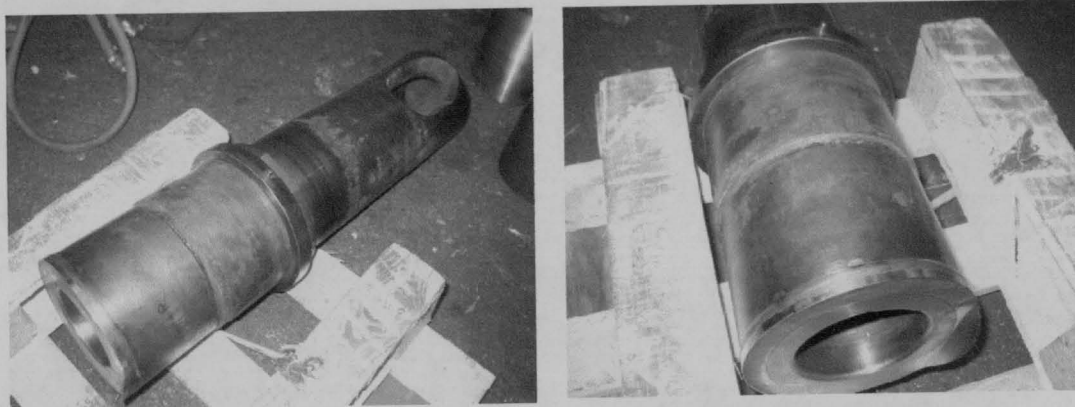
Figura 53 – Camisa de injeção e anéis de refrigeração após realizada a alteração
