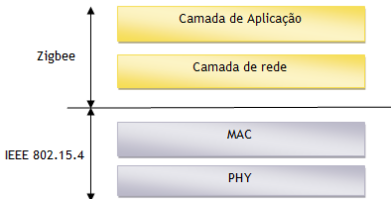
Figura 3.5- Camadas definidas no Zigbee
