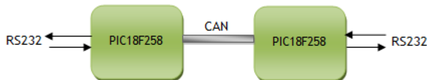
Figura 6.4- Esquema de ligação dos PIC's.
