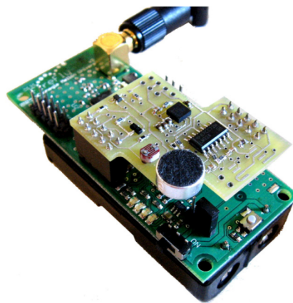
Figura 4.3- FireFly WSN Platform com board expansão de sensores [20]
