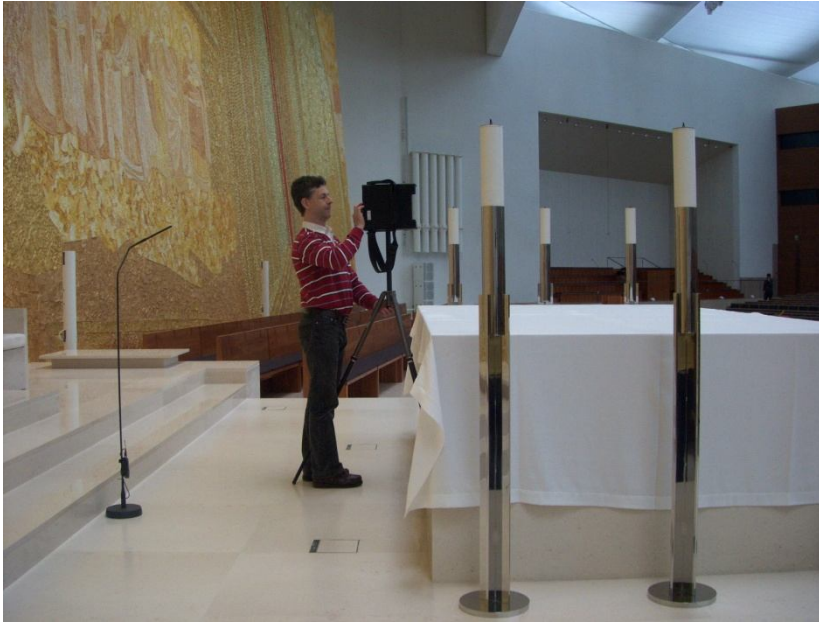
Figura 5.7. – Posição do transmissor do sinal sonoro ao nível do orador para avaliação do RASTI. [Foto do Autor]
