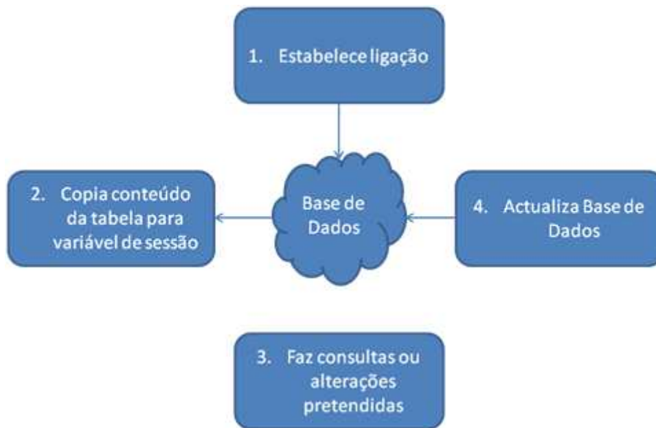
Figura 52 - Princípio de funcionamento da DataTable
