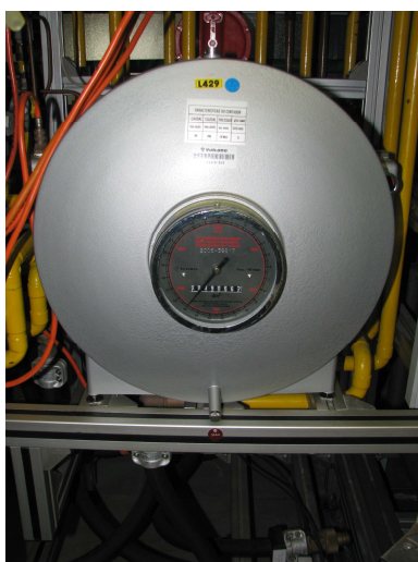
Figura 3-4 - Contador de gás húmido - Actaris
