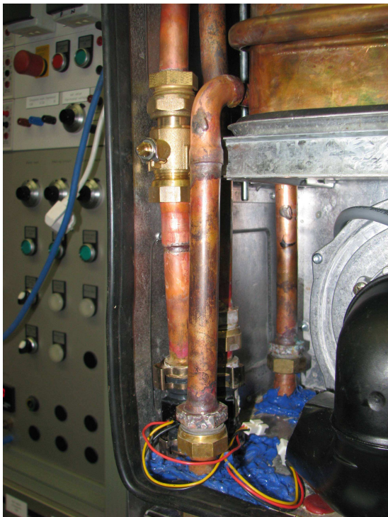
Figura 3-7 - À esquerda podemos ver a posição das turbinas em ambos os circuitos paralelos. À direita uma turbina de medição de caudal
