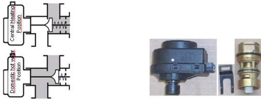
Figura 2-18 - Funcionamento de uma válvula de 3 vias. Imagens: motor e respectiva válvula de 3 vias
