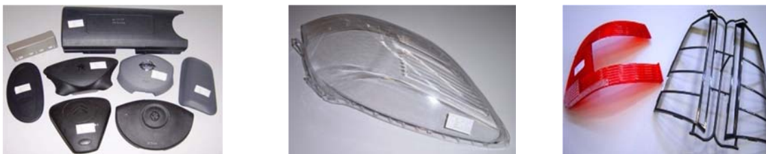
Figura 7. Exemplos de peças produzidas para a indústria automóvel a partir dos moldes feitos na Azemoldes.
