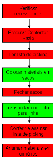
Figura 29 – Esquema representativo da situação inicial de abastecimento
