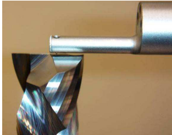
Figura 3-15 Pormenor do apalpador em contacto com a fresa
