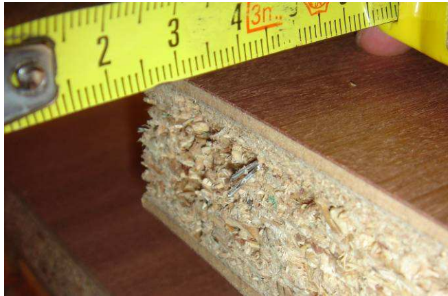
Figura 3-34 Material metálico detectado no aglomerado de partículas
