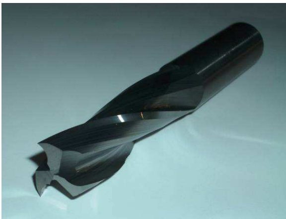
Figura 3-1 Fresa Up de 3 hélices
