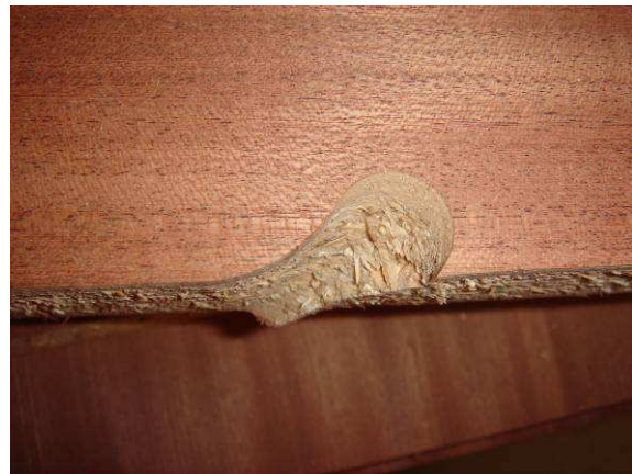
Figuras 3-28 e 3-29 Pormenor da zona de entrada da fresa na placa
