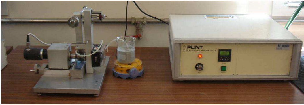
Figura 3-11 Vista geral do tribómetro do INEGI
