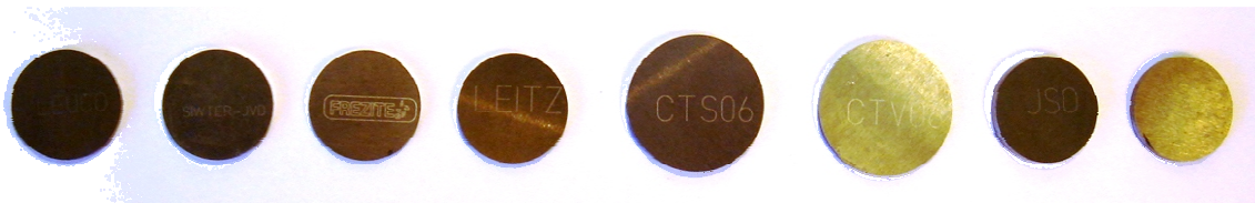
Figura 3-7 Pastilhas para ensaio de desgaste (1º conjunto+Sinter-Sud)
