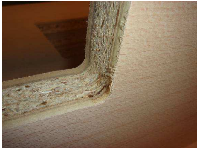
Figura 4-2 Superfície de corte com imperfeições e sinais de sobreaquecimento.
