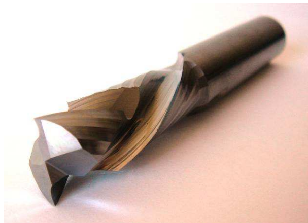
Figura 3-2 Fresa Up/Down de 2 hélices
