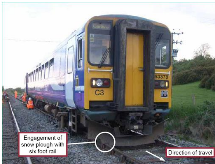
Fig. 2.2 – Parte da frente do comboio e o pormenor do limpa neves sobre os carris (Rail Accident Investigation Branch, 2010, p. 12)
