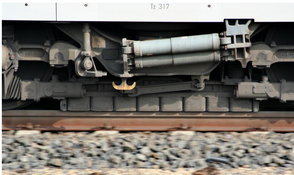
Fig. 4.22 – Travões eddy current de um comboio de alta velocidade alemão (ICE3)
