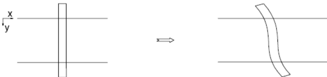
Fig. 5.25 – Deformada das travessas, vista em planta (Lim, N.H. [et al.], 2003)
