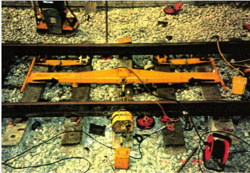
Fig. 2.7 – Equipamento de arranque do ensaio STPT (Hunt, G. and Yu, Z., 1998)
