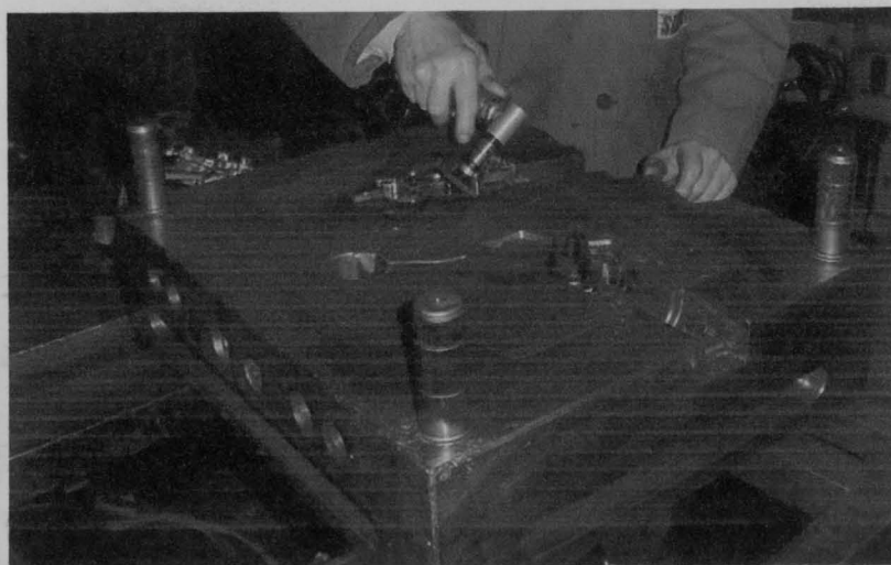
Figura 38 – Limpeza da zona de fecho
