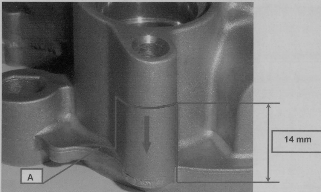
Figura 10 – Indicação do material retirado à peça
