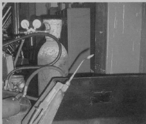
Figura 16 – Soldadura com Oxiacetileno
