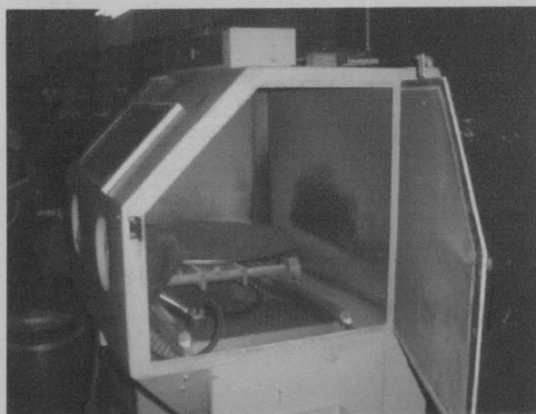
Figura 13 – Vista lateral da Máquina de Jacto de Areia
