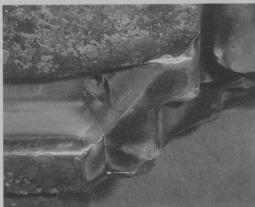
Figura 25 –Desgaste da zona de ataque
