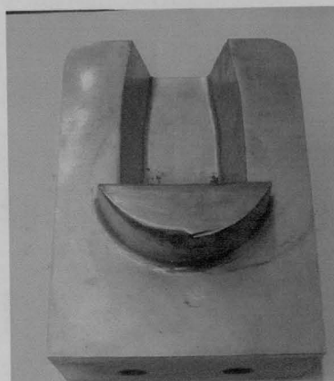
Figura 36 – Inserção de Impacto reparada
