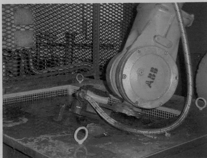
Figura 9 – Arrefecimento do jito no tanque
