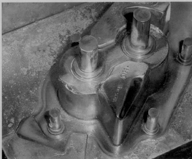
Figura 29 – Desgaste nas arestas e pernos da cavidade
