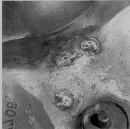
Figura 30 – Enchimento na cavidade
