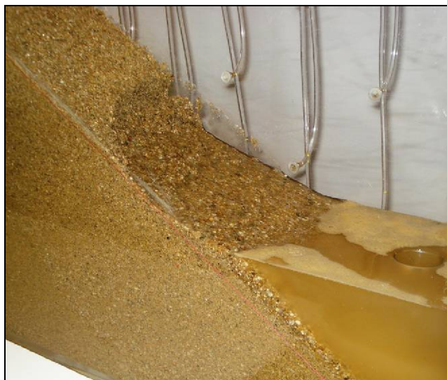
Fig. 4.11 – Rotura provocada pela erosão interna na barragem.
