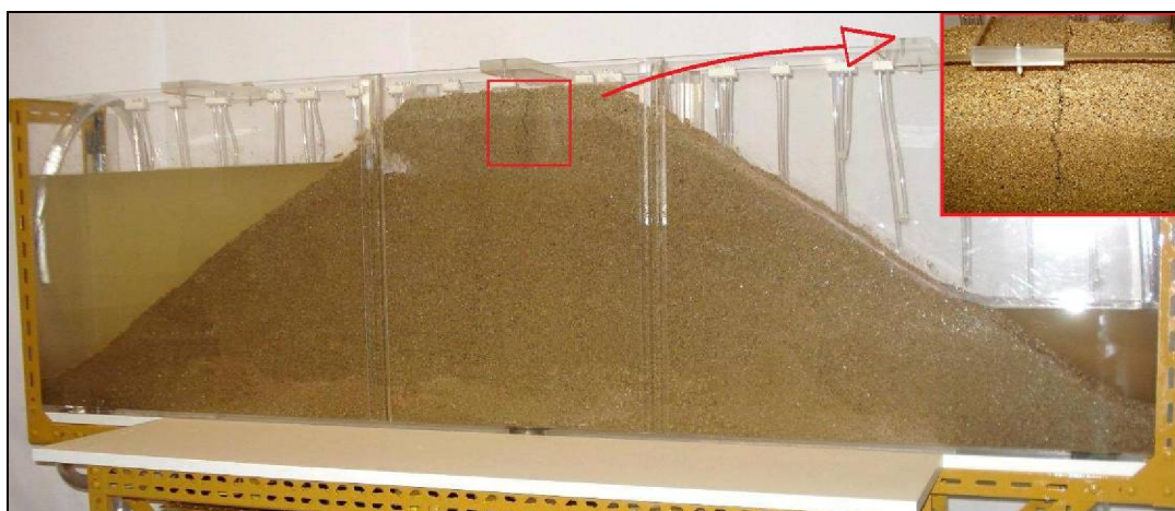
Fig. 4.10 – Fotografia da barragem de aterro em enchimento com fenda no coroamento.
