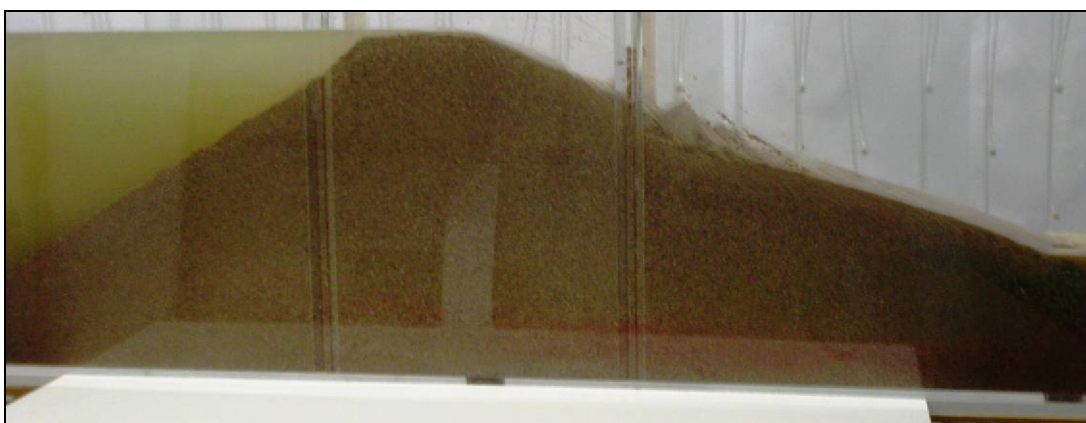
Fig. 4.15 – Rotura da barragem.
