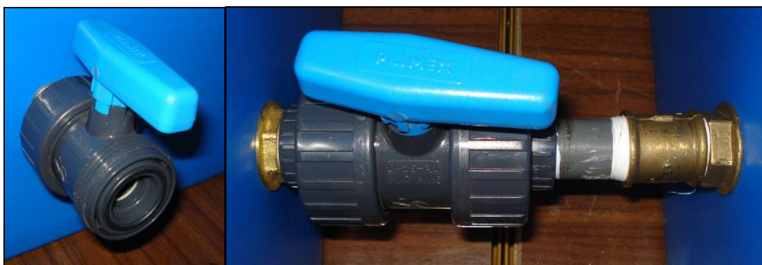
Fig. 3.15 – Válvula na ligação entre reservatórios.
