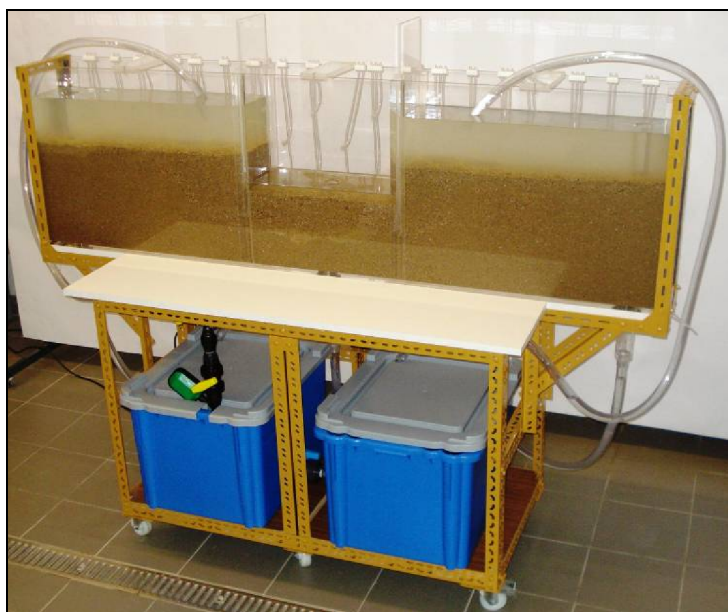
Fig. 4.3 – Fotografia do ensaio da ensecadeira em regime permanente de escoamento.
