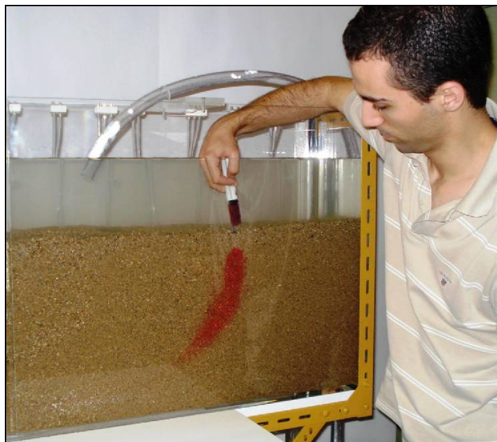
Fig. 4.4 – Injecção do corante no lado exterior à ensecadeira.
