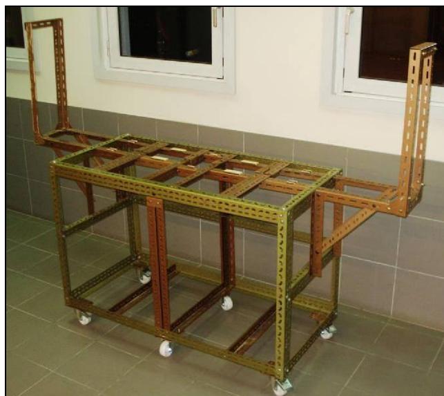
Fig. 3.10 – Estrutura de suporte com rodas.
