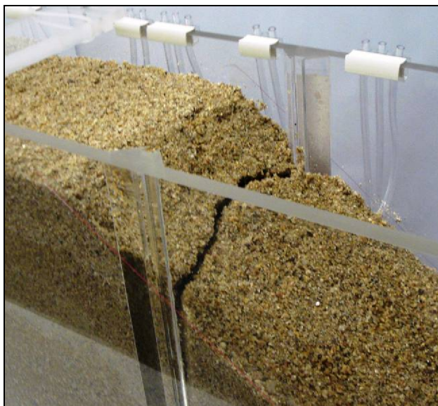
Fig. 4.14 – Fenda no paramento de jusante da barragem.
