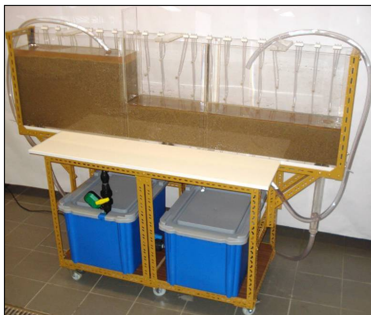
Fig. 4.8 – Fotografia do ensaio da cortina com percolação em regime permanente.
