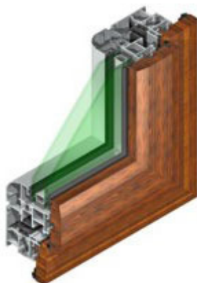
Figura 2-16: Corte de janela de alumínio -madeira [26]
