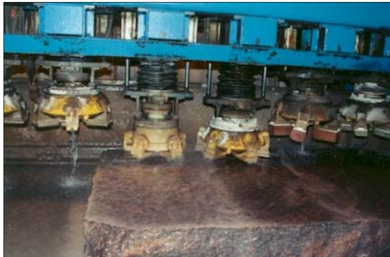
Figura 7 – Cabeças da máquina de polir com os elementos abrasivos “tipo Fickert” ( http://www.hollistersmonument.com/process.htm )
