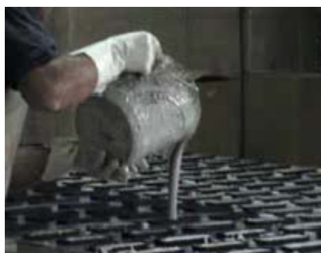
Figura 10 – Vazamento de massa abrasiva nos moldes colocados nas mesas (Abralux)
