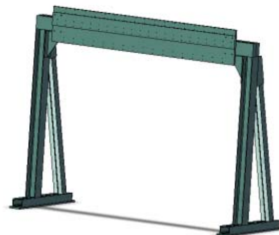
Figura 29 – Estrutura principal do manipulador em construção soldada
