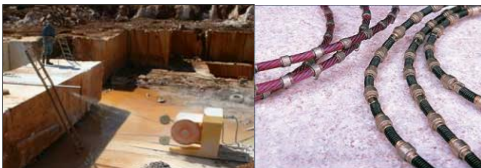
Figura 2 - a) Corte da pedra nas pedreiras por fio de corte diamantado; b) Fio de corte diamantado ( http://www.cairnsmarble.com )
