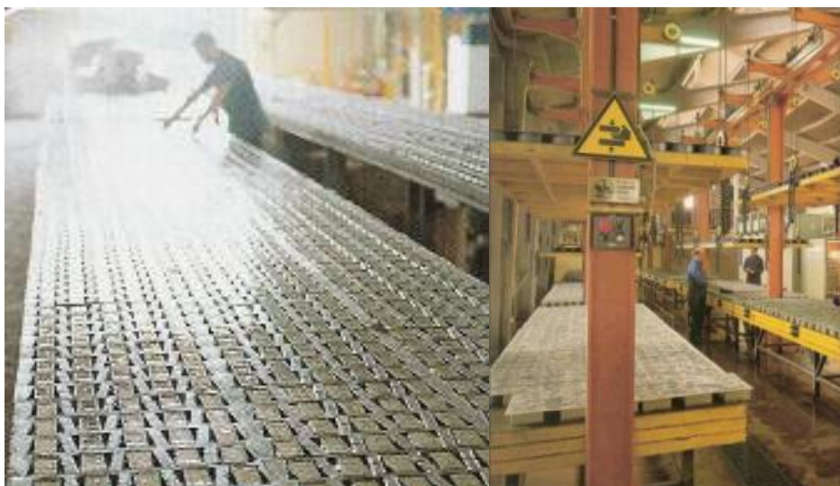
Figura 11 – a) Pré-endurecimento em mesa 4 ; b) Pré-endurecimento em mesa de tampo móvel 4
