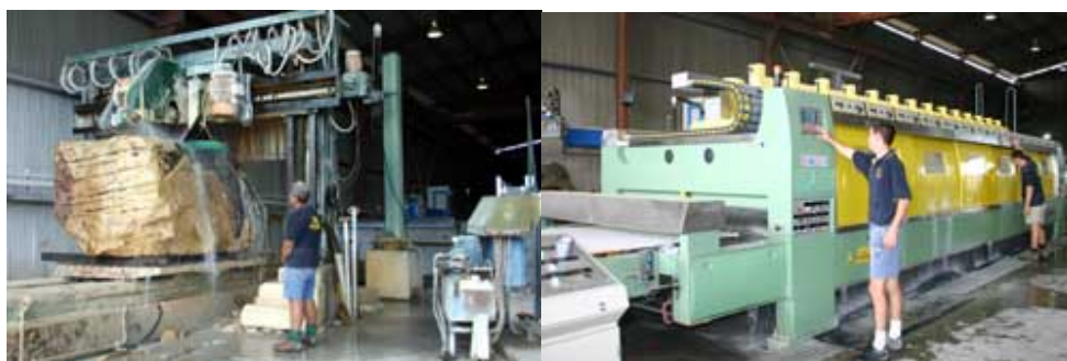
Figura 4 - a) Corte do bloco de pedra em lâminas; b) Polimento das lâminas de pedra com uma máquina de cabeça oscilante ( http://www.cairnsmarble.com )
