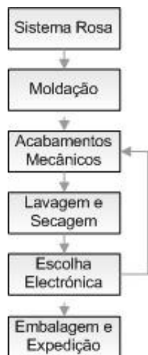
Figura 9 - Fluxo produtivo da rolha NT
