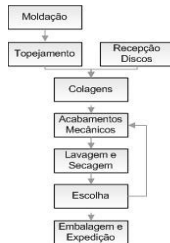
Figura 10 – Fluxo produtivo da rolha TT
