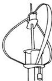
Figura 5 - Esquema do rotor de Darrieus
