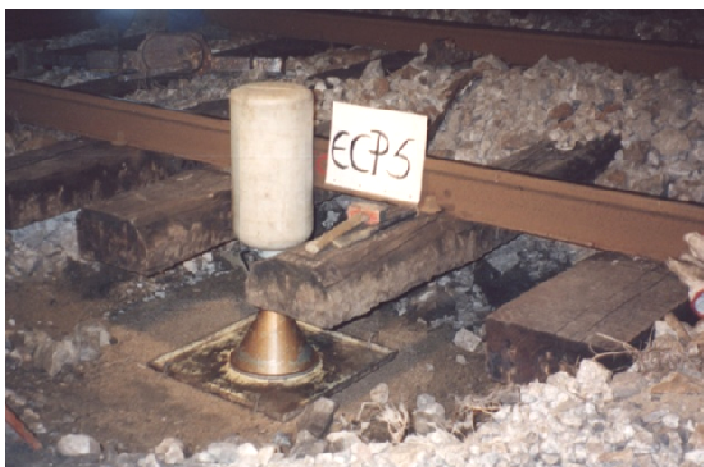
Figura 4. 2: Ensaio pelo Método da Garrafa de Areia (adaptado de REFER E.P., 2001).
