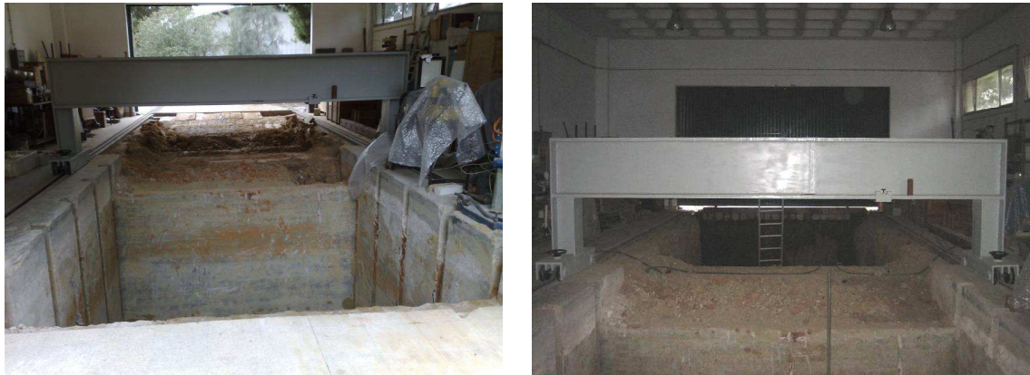
Figura 5. 3: Ilustração do pórtico de reacção para realização de ensaios de carga (adoptado de LNEC, 2010).
