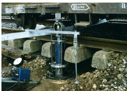
Figura 2. 10: Imagem de execução do ECP numa via férrea em serviço (adaptado de Fortunato et al., 2009).
