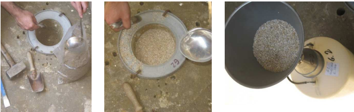
Figura 5. 5: Ilustração de etapas do Método da Garrafa de Areia.
