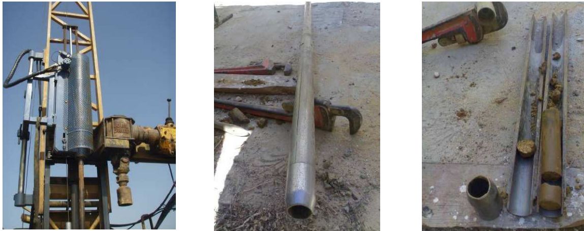
Figura 2. 7: Aspecto do equipamento do ensaio SPT (pilão automático e amostrador SPT - Terzaghi).
