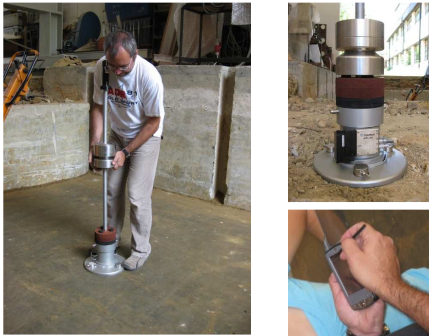
Figura 5. 7: Deflectómetro de Impacto Portátil (DIP).
