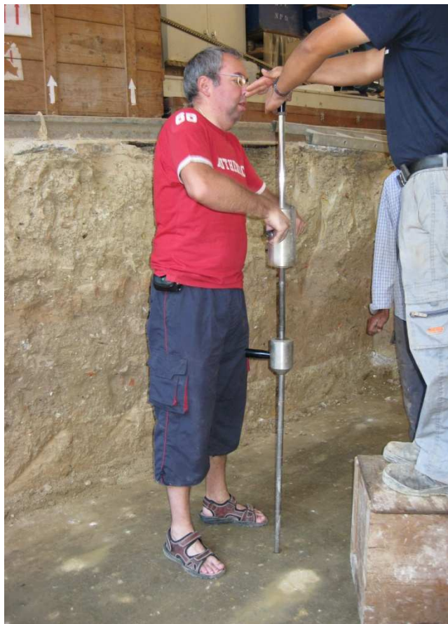
Figura 5. 8: Ensaio com o Penetrômetro Dinâmico Ligeiro (DPL).
