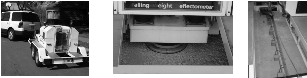
Figura 2. 14: a) Equipamento do Deflectómetro de Impacto (FWD); b) Placa de carga; c) Geofones. (adaptado de Pestana, 2008)
