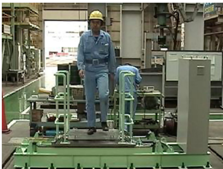
Figura 5.10 – Peão em movimento sobre a mesa sísmica de Nakamura [19]
