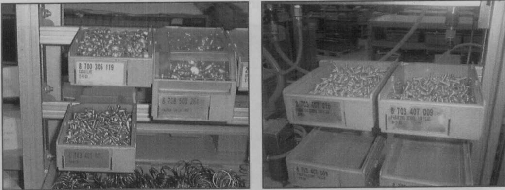
Figura 5.28 – Falta de Tampas em Material Crítico
