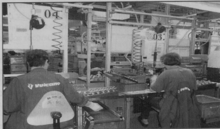
Figura 5.18 – Operadoras a Montarem os Automáticos de Gás
