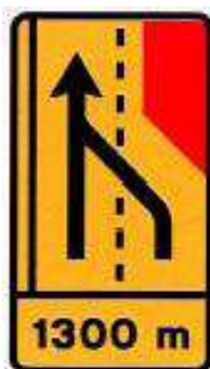
ST2 – Supressão de via de trânsito
