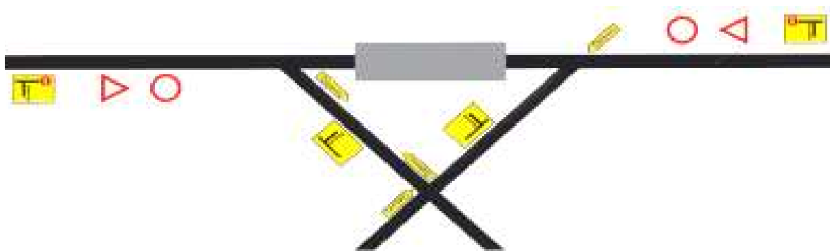
Figura 18 – Esquema de desvio de itinerário (adaptado JAE, 1997)
