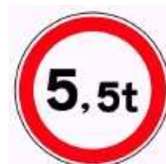
Figura 11 – Trânsito proibido a veículos de peso total superior a ...t (C6)
