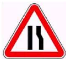
A4c – Passagem estreita
