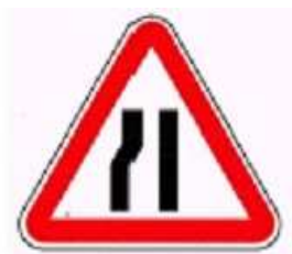
A4b – Passagem estreita
