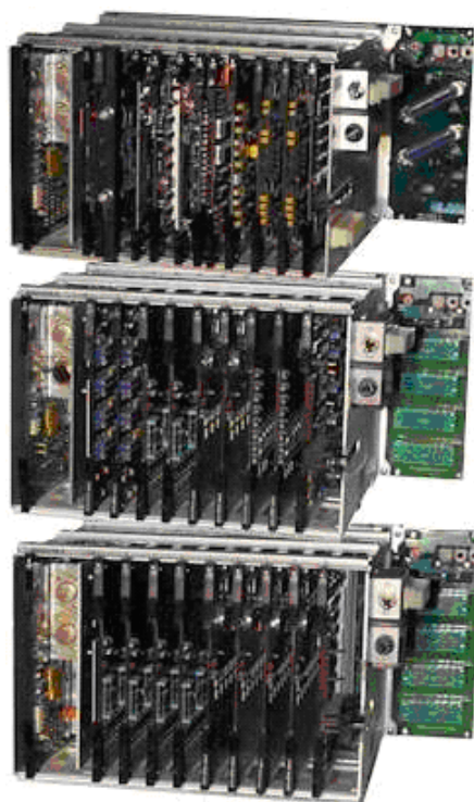
Figura 3.5 - Controladores do DCS TDC 2000 da Honeywell [8].
