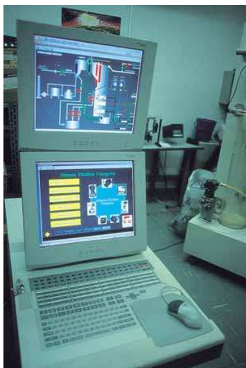
Figura 3.6 - HMI do DCS CENTUM da Yokogawa [9].
