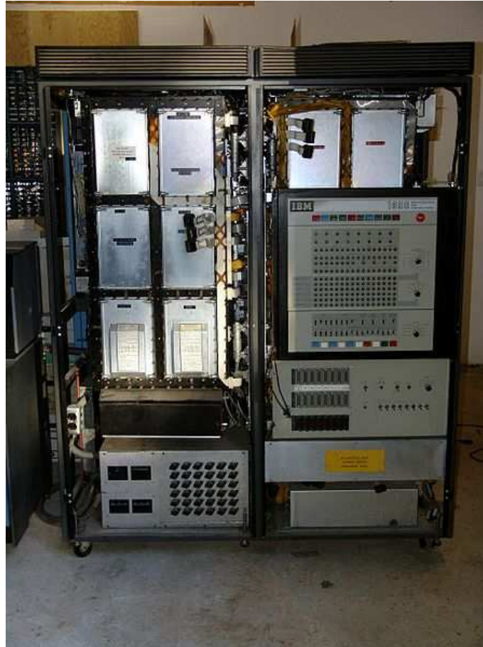
Figura 3.4 - IBM 1800: Aquisição de dados e sistema de controlo centralizado [7].
