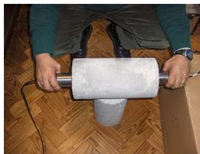
Figura 3.23 – a) Malha plana de elementos finitos; b) ensaio de ultra-sons em provete de betão para determinar experimentalmente o módulo de elasticidade do betão (módulo de elasticidade dinâmico).
