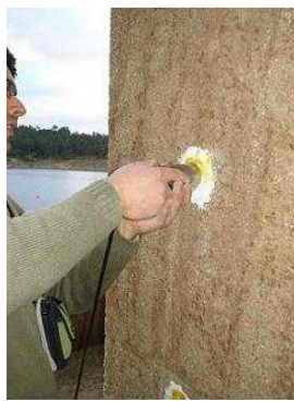
Figura 5.20 – Ensaio de ultra-sons para determinar o módulo de elasticidade do betão da torre das tomadas de água.
