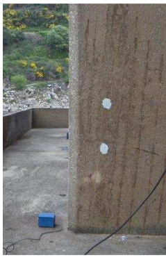
Figura 5.20 – Ensaio de ultra-sons para determinar o módulo de elasticidade do betão da torre das tomadas de água.
