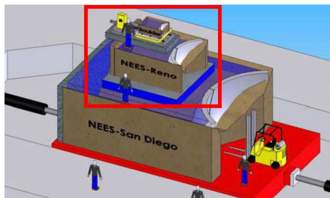
Figura 2.39 – Comparação de mesas sísmicas de diferentes dimensões (Saouma, et al., 2007).
