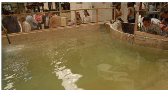
Figura 2.36 – Modelo físico da barragem de Odiáxere com albufeira (modelo à escala 1:40). Estudo dinâmico na mesa sísmica do LNEC (Gomes, 2010).
