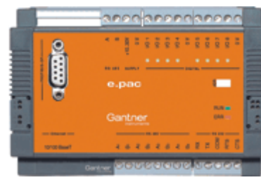
Marca: Gantner ( http://www.gantner-instruments.com ) Modelo: e.pac RAM: 16 MByte Redes: possibilidade de ligar 4 redes RS485 para módulos e.bloxx Ligação: Ethernet com 10/100 Mbps, FTP, TCP/IP, UDP
