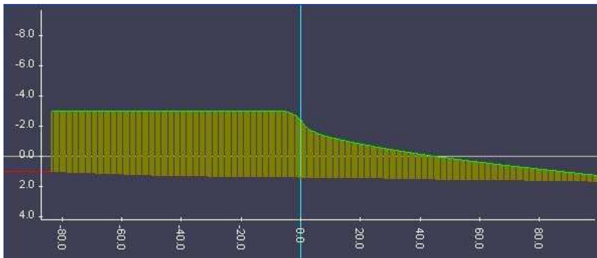
Figura C4 - Perfil transversal da nova linha de costa situada a sul, para o ponto P_0 (linha a verde representa o novo perfil do terreno, linha vermelha o perfil sem o tómbolo e a zona amarelada o volume adicional de areia para a formação do tómbolo)
