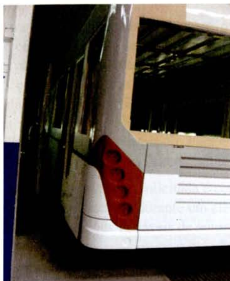
Figura 10 – Autocarro com superfícies tratadas e esmaltadas na 2ª fase da Pintura
