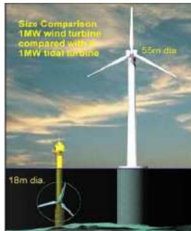
Figura 4.12 - Comparação entre turbinas eólica e marés [62].
