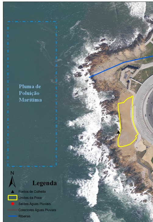
Figura 26 – PAB do Castelo do Queijo, representação das potenciais fontes de poluição que podem condicionar a qualidade das águas balneares do Castelo do Queijo
