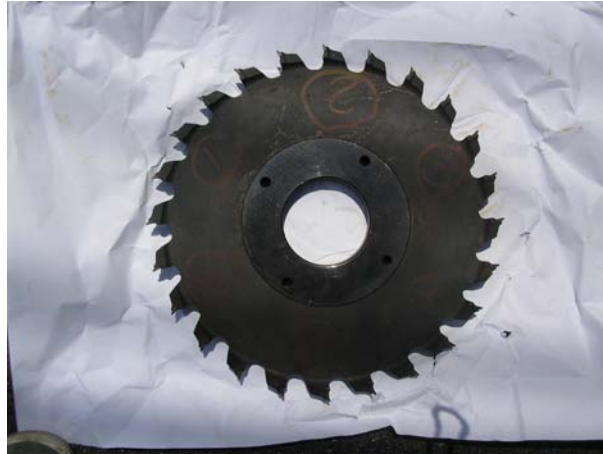
Figura 42 – Ferramenta de corte de diamante policristalino com bits de PCD de grão médio (10 µm) da ELEMENT SIX.
