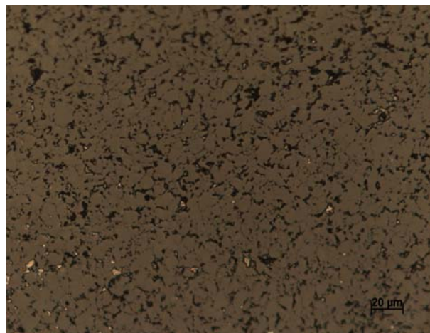
Figura 32 – Fotomicrografia do diamante policristalino CMW: fase clara – grãos de diamante; fase escura – cobalto. Amp. 500x.
