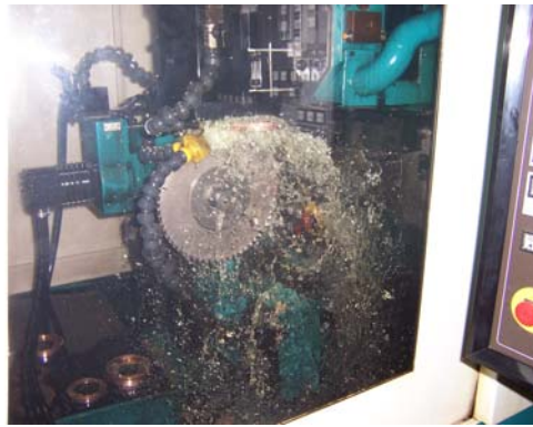
Figura 33 – Afiamento por electroerosão da ferramenta de diamante policristalino (ILJIN) na Vollmer QM 110 eco.
