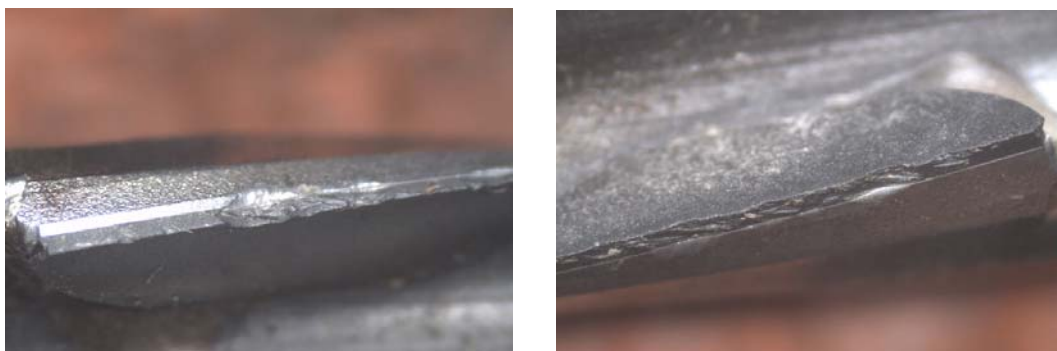
Figura 9 – “ Chipping ” de um bit numa broca de PCD utilizada no corte de piso flutuante.
