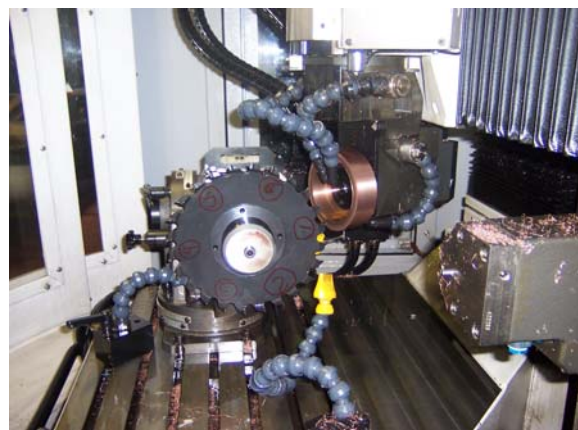
Figura 44 – Electroerosão por mó da ferramenta de diamante policristalino na Vollmer QM 110 eco.
