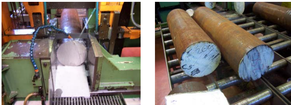
Figura 26 – Corte por serra mecânica das patelas de aço.
