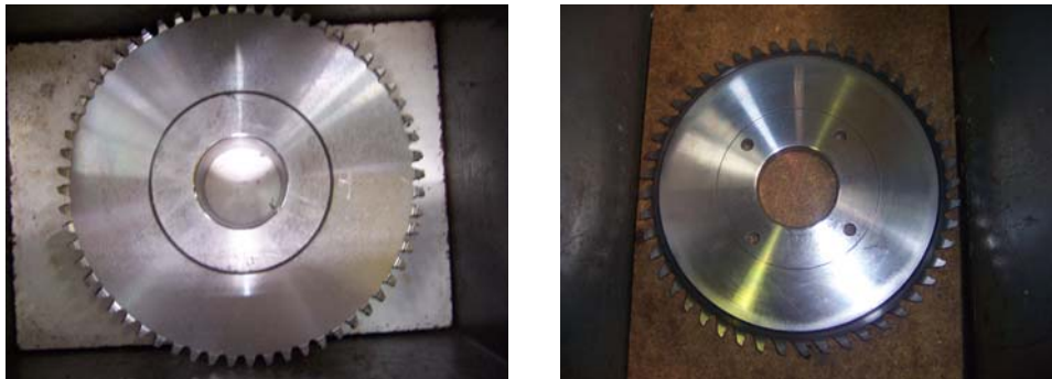
Figura 28 – Aspecto das ferramentas após operação de fresagem: a) Parte I; b) Parte II (ver tabela 5).
