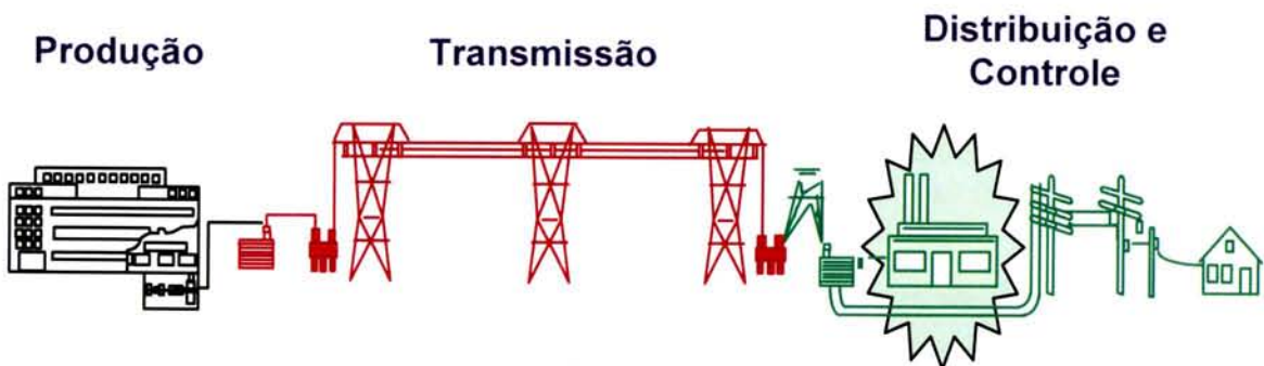
Figura 2 – Cadeia representativa do Sistema Eléctrico de Energia (SEE)
