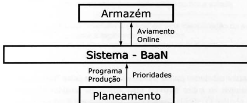
Figura 14 – Processo novo de aviamento
