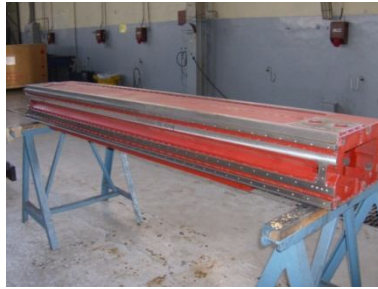
Figura 43 – Estrutura do pórtico
