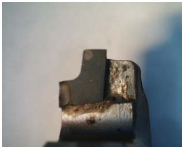
Figura 3.10 - Desgaste de cratera e quebra
