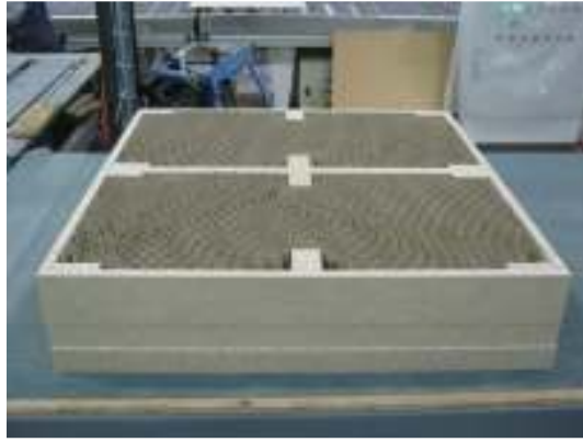
Figura 3.5 - Frame após enchimento com papel " favo de mel "
