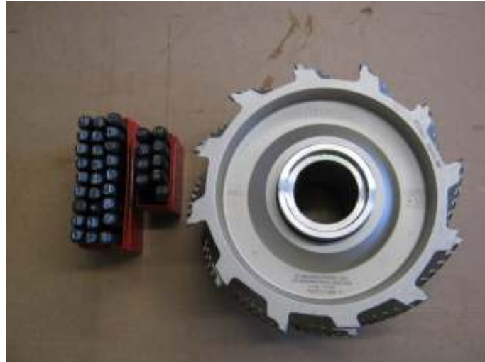
Figura 4.1 - Conjunto de punções e ferramenta a marcar
