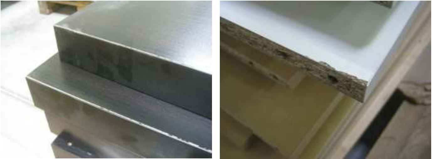
Figura 3.12 - Defeitos originados por má qualidade de corte
