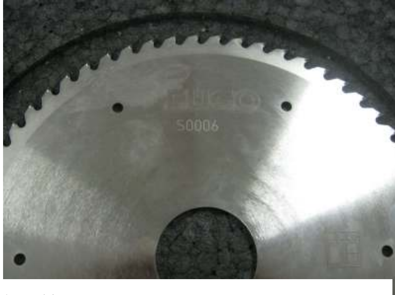
Figura 4.3 - Marcação por laser
