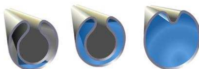
Fig. 5.14 – Enchimento das pregagens “Swellex” com água a alta pressão [42]
