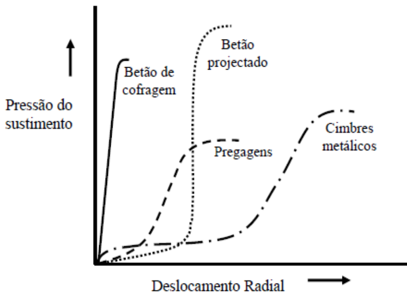
Figura 3. 26 - Curvas características de alguns tipos de suporte (Hoek, 1980, 1997).
