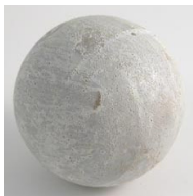
Figura 2.32: Cobertura do núcleo com uma solução de borracha
