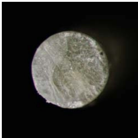
Figura 2.12: Vista da secção de uma corda de tripa natural (ampliação de 32x).
