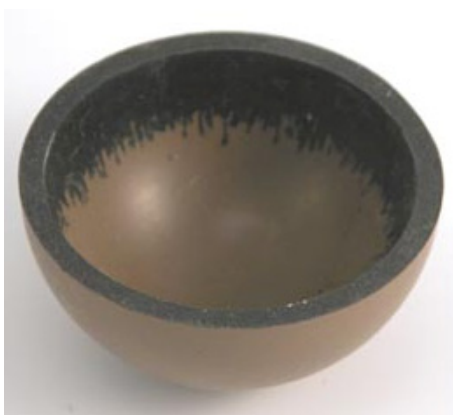
Figura 2.29: Bordo da calote de borracha desgastada para colagem.
