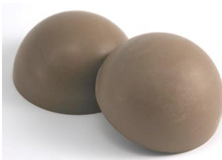
Figura 2.28: Meias cascas esféricas do núcleo de borracha.
