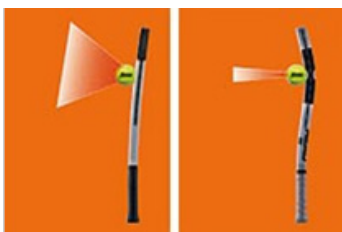
Figura 6.2: Movimento de uma raquete durante o impacto de uma bola de ténis. Esquerda: raquete tradicional. Direita: raquete com o sistema Flexpoint TM .
