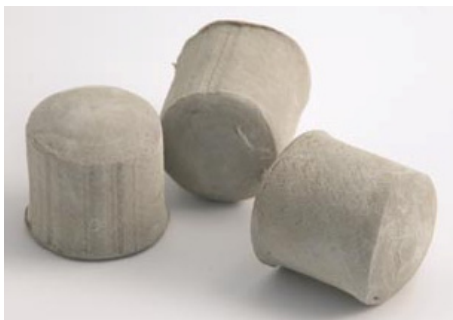
Figura 2.27: Bocados de borracha extrudidos e cortados.
