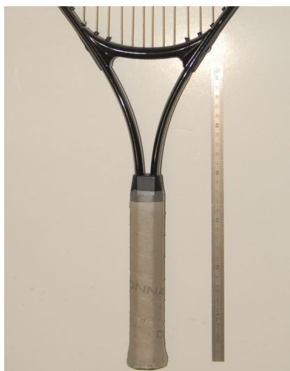
Figura 2.6: Raquete de alumínio. Nesta figura podem ver-se os dois tubos que ligam ao cabo.
