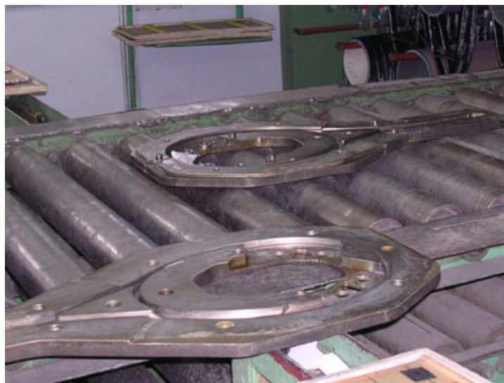
Figura 2.10: Molde de uma raquete de ténis.
