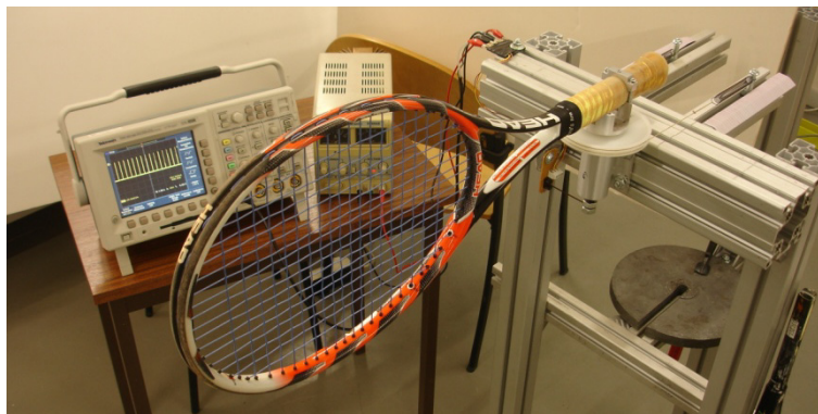
Figura 5.7: Sistema que permite a avaliação do momento de inércia de uma raquete de ténis.
