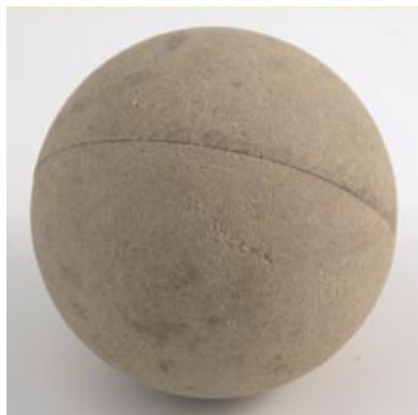
Figura 2.31: Superfície após desbaste.
