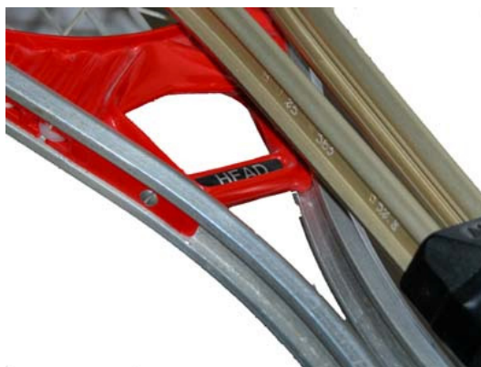
Figura 2.7: Exemplo de uma raquete metálica de 1970 com perfil em I. Neste caso a ponte, peça de plástico, está fixa ao quadro através de parafusos.
