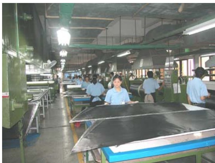
Figura 2.9: Exemplo de produção de tecidos de pré-impregnados.
