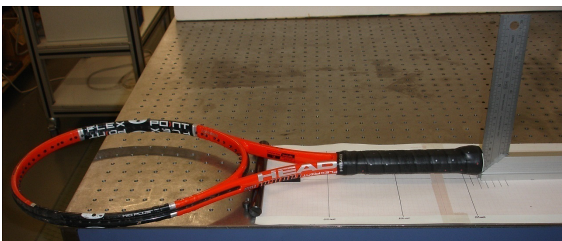
Figura 3.5: Disposição dos elementos para a caracterização do centro de massa da raquete Head Flexpoint Radical Tour .
