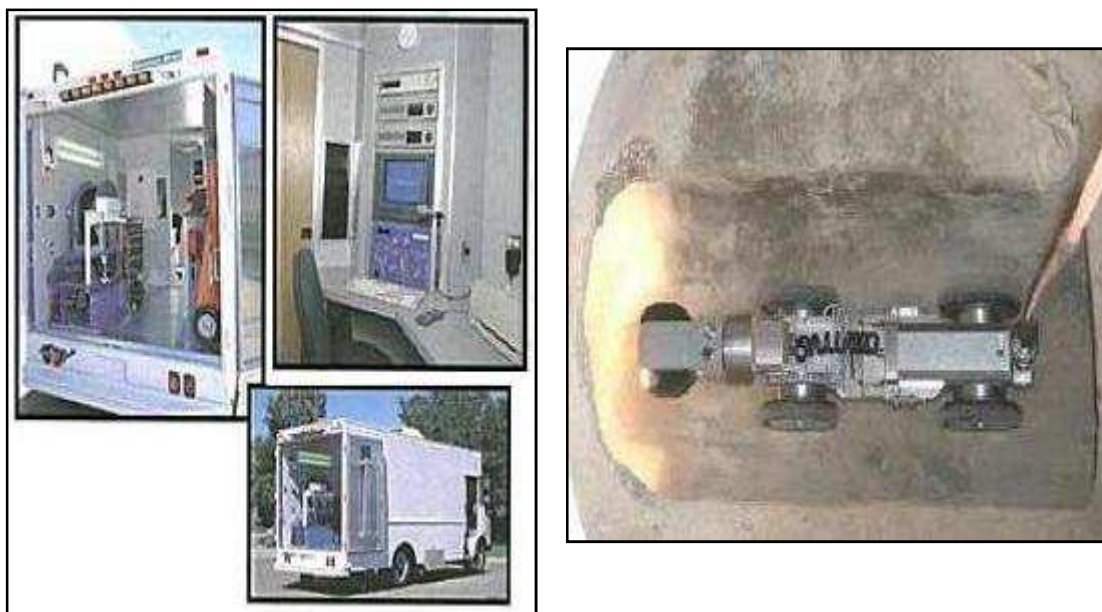
Figura 3.2 – Ferramentas para Detecção de fugas por meio de sistema vídeo – Posto Móvel e Robot de Inspeção Vídeo (Exemplo)
