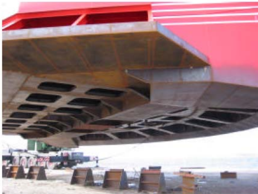
Figura 2.28 – Protótipo do Wave Dragon durante o lançamento em Março de 2003. As aberturas da câmara de ar utilizadas no sistema de controlo de estabilidade [38].
