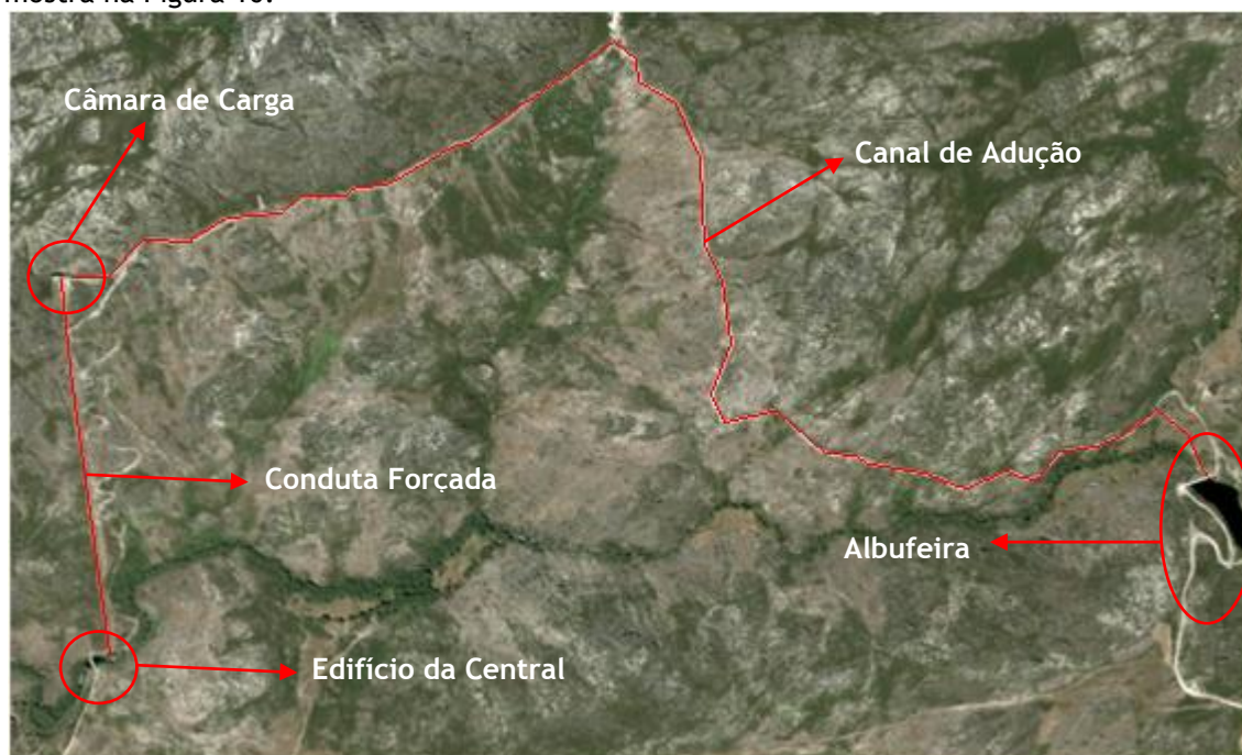
Figura 9 - Central de Fio-de-Água.
