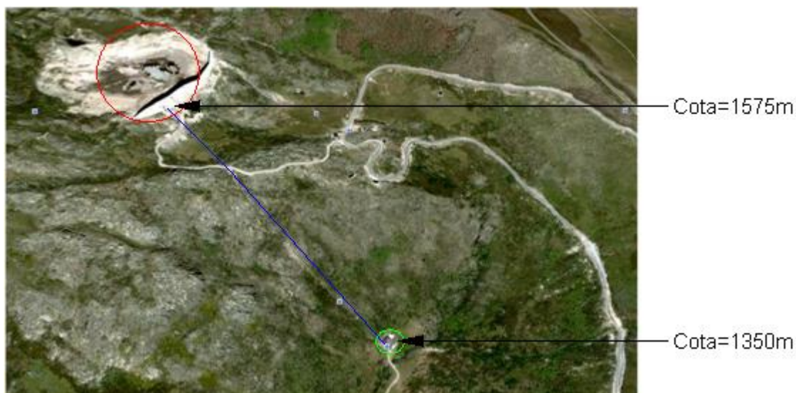
Figura 22 - Central só com Conduta Forçada.
