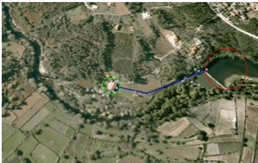
Figura 24 - Central só com Canal de Adução.
