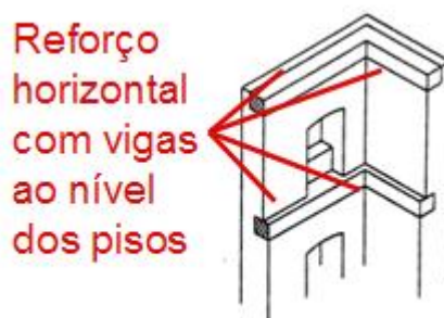
Fig.4.3 – Pormenor de reforço horizontal
