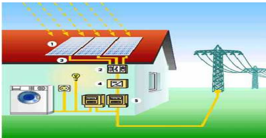
Figura 2.12 - Sistema fotovoltaico ligado à rede [8]
