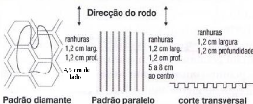
Figura 9 medidas para o piso (adaptado de Cortez & Cortez, 2006)
