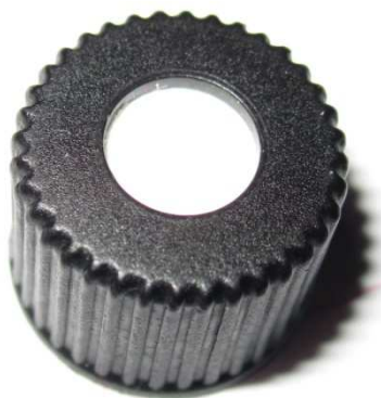
Figura A3.15. e A3.16 – Capas com camadas de filtro Whatman nº 1 usadas na ponta da fibra de vidro 15
