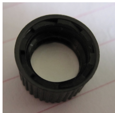
Figura A3.15. e A3.16 – Capas com camadas de filtro Whatman nº 1 usadas na ponta da fibra de vidro 15
