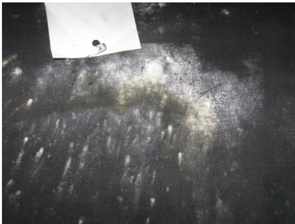
Figura A1.6. – Evidências da presença de colônias de fungos na parte inferior de um tampo de cadeira reserva de cadeira de Kenwood House) 6
