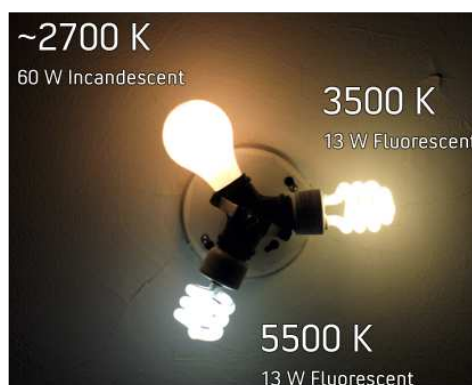
Figura 4.6. – Comparação da Tc de várias fontes de luz eléctricas 376 .
