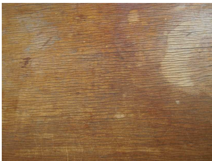
Figura A.20. – Pormenor do dano provocado por níveis de HR demasiado baixos em peça de mobiliário 14 .
