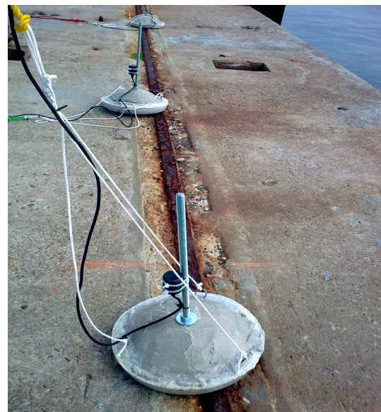
Figura 5 - set-up experimental. esquerda - altifalante e os dois primeiros hidrofones foram fixados a uma estrutura de heliaco; direita - hidrofones foram fixados a hastes de aço.
