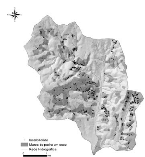
Figura 3. Instabilidade observada nos muros de pedra em seco na Bacia Hidrográfica da Ribeira da Meia Légua.
