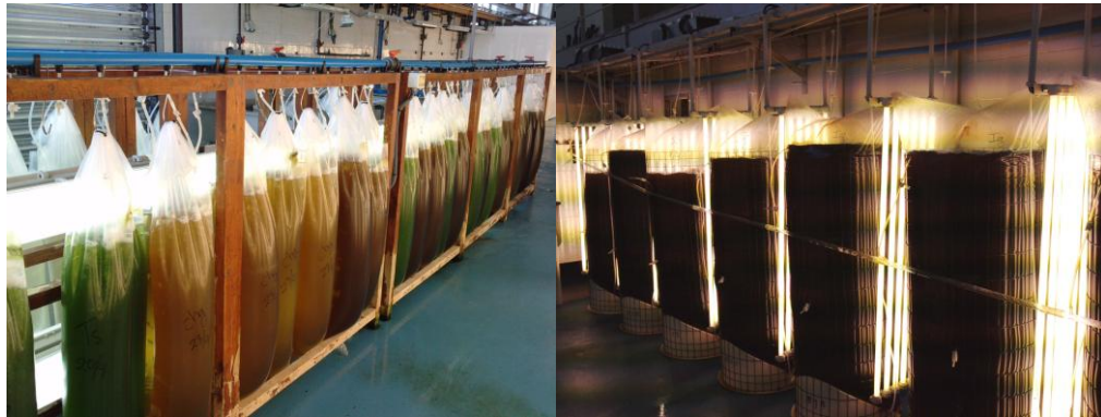
Figura 1 – Exemplo de sistemas de produção de microalgas em bolsas de plástico de volume variável. (Fotografias: Pedro Seixas).
