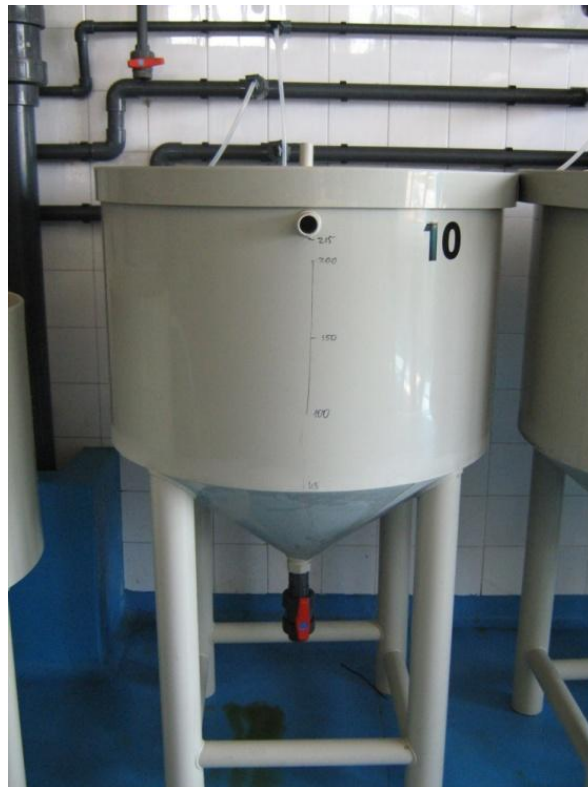
Figura 15 – Tanque cónico de fibra de vidro de 220 L de capacidade utilizado para a criação das larvas de Ruditapes philippinarum , alimentadas com duas dietas diferentes (Fotografia: Pedro Nascimento)
