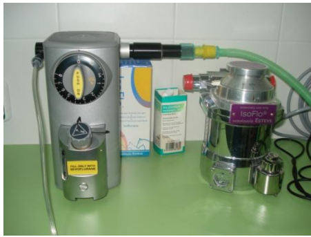
Figura 15. Vaporizadores: o do sevoflurano (à esquerda) e o do isoflurano (à direita)
