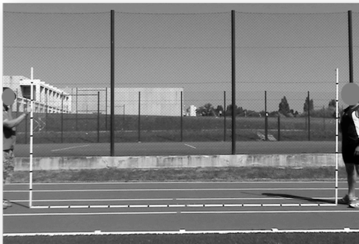
Figura 22: Estrutura metálica usada como dispositivo de calibração (escala, referencial).
