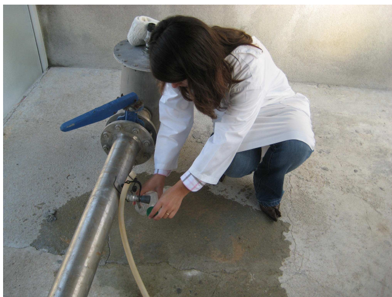
Figura 2-1 – Recolha de água termal de S. Pedro do Sul através do furo.
