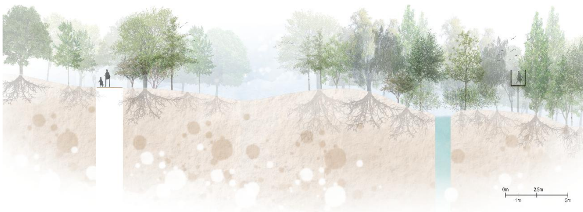
Figura 44 - Corte Transversal C-C', zona de talude inclinado, galeria ripícola e bacia de retenção | Fonte: João Soares
