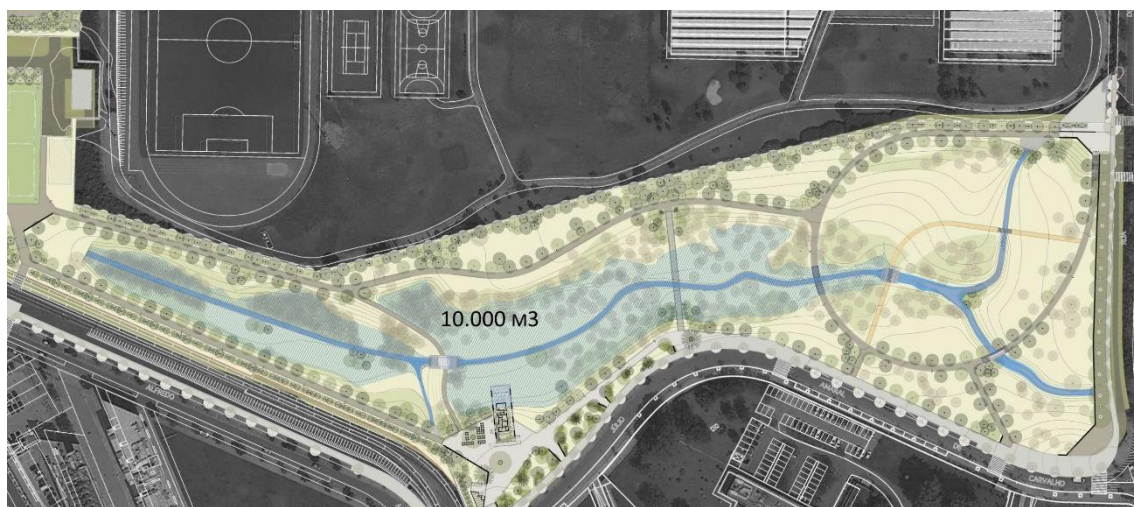
Figura 18 - Planta do Parque da Asprela, com representação da área de retenção temporária de águas pluviais. | Fonte: Biennial Internacional de Paisatge, «Parque da Asprela», s.d.
