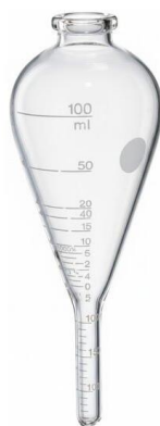
Figura 14 - Tubo periforme de sedimentação (100 mL) utilizado no ensaio de estabilidade ao frio [28].
