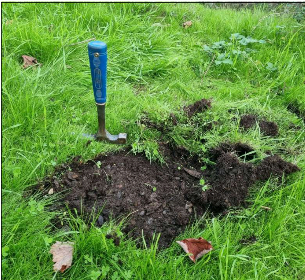
Figura 11. Ponto de amostragem de solo superficial (0 cm-20 cm) na envolvente da mina de Rio de Frades referente ao ponto RF-11, local fora da zona de influência. Fonte: Acervo pessoal.
